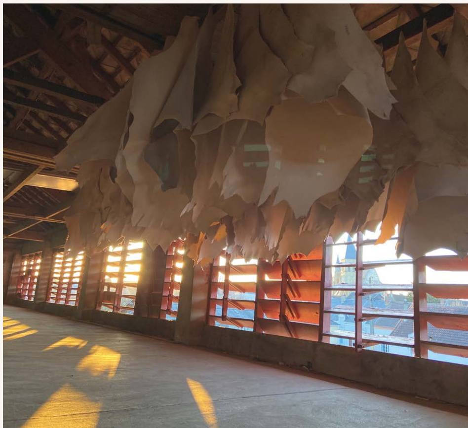
↑ Sèche dans la mégisserie Rousseau, correspondant à l'étape indispensable du processus de valorisation de la peau.
